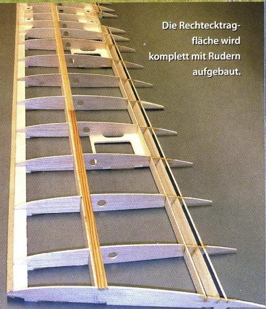
Die Rechtecktragfläche wird komplett mit Rudern aufgebaut.
